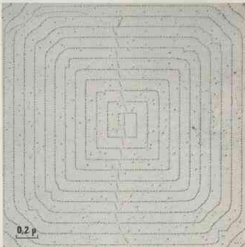
Interaction entre les gouttes d'une source d'évaporation sur une face (100) de NaCl et des lignes de glissement de dislocations [Chapon — Matalashiev]
