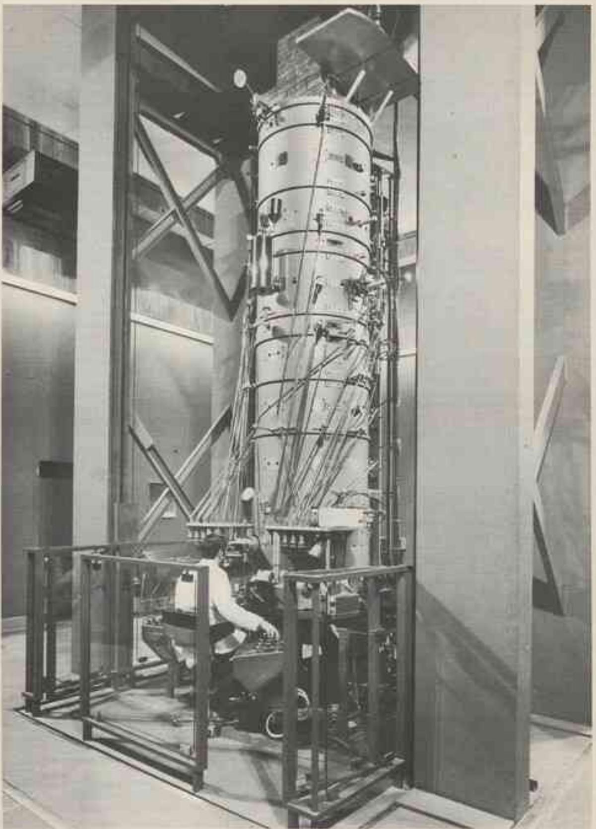
Fig. 2. — Microscope 3 MV. On note sur la face avant de l'appareil le dispositif d'anticommanageur à Thénium liquide. Au même niveau à droite le portefeuillet goniométrique permettant une inclinaison de  $\pm 35^\circ$  dans toutes les directions.
