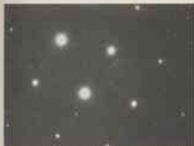
Fig. 24. — Diagramme de diffraction correspondant à un alliage Fe-Cr à mailles orthorhombiques qui peut être attaché comme la répétition d'une maille quadratique centrée FeCr. Distance périodique de 2,78 Å. Cette périodicité a été mise en évidence en combinant deux faisceaux dus à la structure ordonnée de l'alliage (voir le diagramme) avec deux faisceaux, désordonnés, sont mis en évidence par l'image sur écran du diffractogramme correspondant (P. Corbion, F. Reynaud, A. Lissacq).
