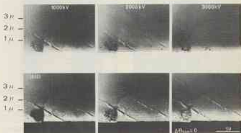
Fig. 7 — Les six clichés montrent l'évolution de la pénétration en sections de Bragg axiales avec 1 MV et 3 MV. Le maximum de pénétration semble être pour 2 MV environ. (A. Roehner, R. Ayroos, A. Maut, C. Mori, B. Jouffrey, 3rd Internat. Conf. on High Voltage Electron Microscopy, Oxford, 1972).
