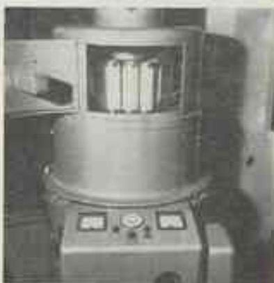
Xenotest : appareil permettant de vérifier artificiellement tous les matériaux par les rayonnements émis à l'aide d'une lampe au xénon. Ici, l'intérieur de la chambre d'échantillon. On aperçoit les supports de papier disposés sur la porte-échantillon cylindrique devant tourner autour de la lampe au xénon.
