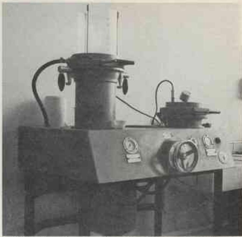
Appareil pour la détermination du coefficient de viscosité d'une solution de cellulose dans le cuivrehydrogène dissous.
