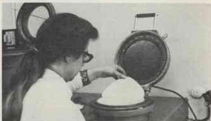
Détail de l'appareil porosimètre. Le papier soumis à l'écoulement dans la partie terminale qui l'attire vers le bas est décomposé.
