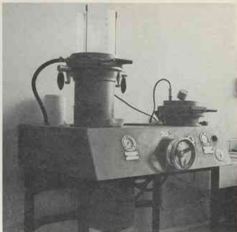
Appareil pour la fabrication expérimentale d'une feuille de papier. A gauche : dispositif pour la formation de la feuille surmontée d'une table dans laquelle on verse la pâte défilée et ses additifs (huile, colorants, etc.). A droite : la presse chauffante pour sécher la feuille obtenue.
