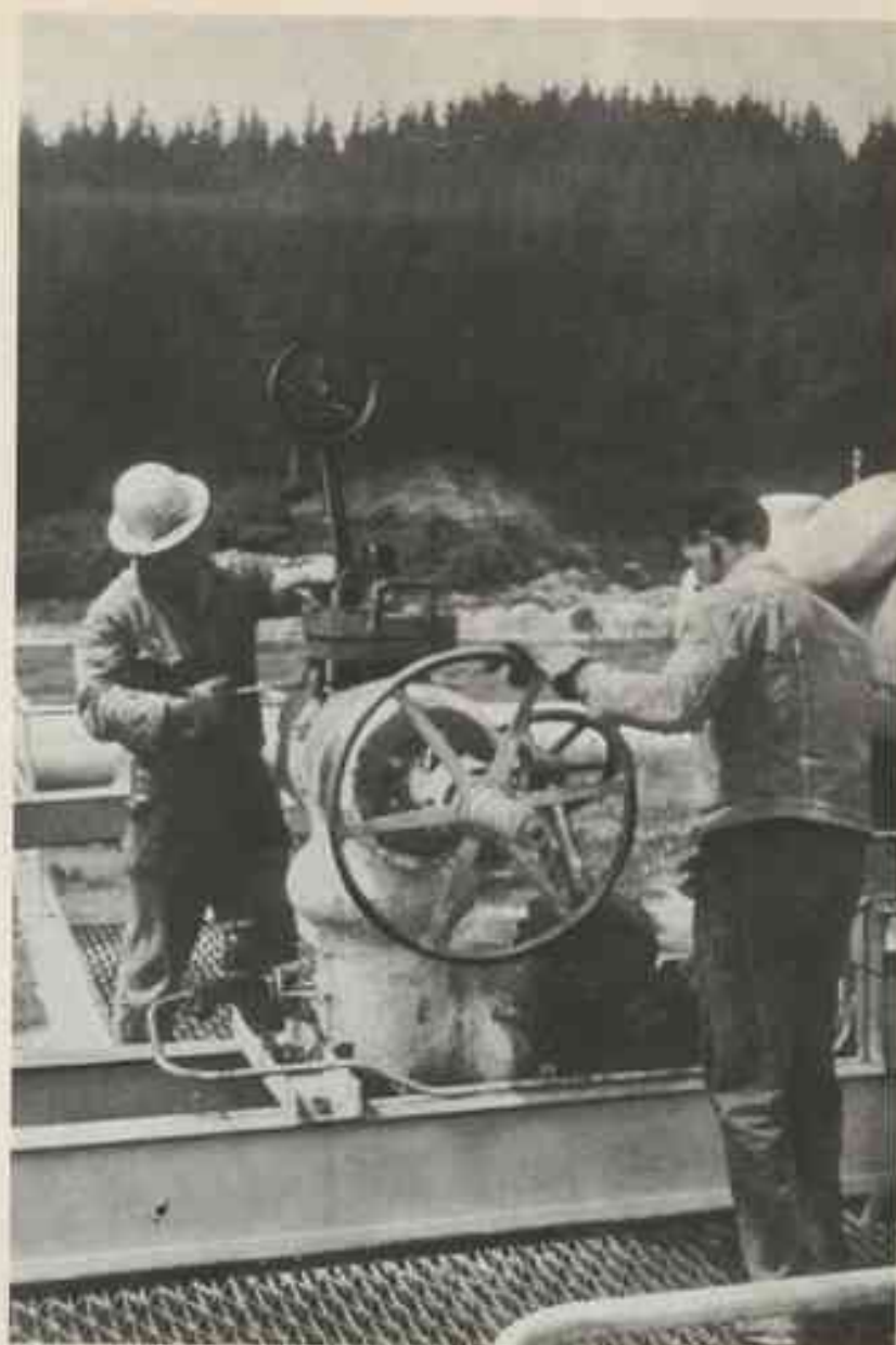
Mesure du profil thermique d'un puits. Le thermobarographe est glissé dans le puits fermé.
