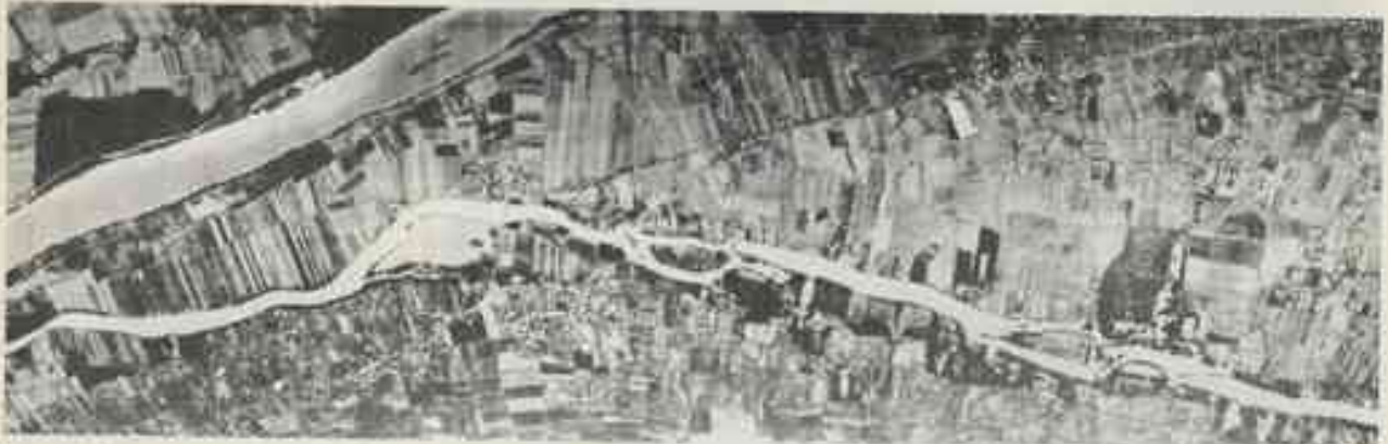
Photographie nocturne proche du confluent de la Loire et de la Vienne. La température de la Loire est moins élevée et moins régulière que celle de la Vienne. Les détecteurs Hg_{0.8}Cd_{0.2}Te construits par le SAT (brevet CNRS) ont une détectivité de : 4 \cdot 10^{19} \text{ cm}^2/\text{A} \cdot \text{W}^{1/2} à 11 \mu\text{m} et une rapidité de l'ordre de la nanoseconde.
