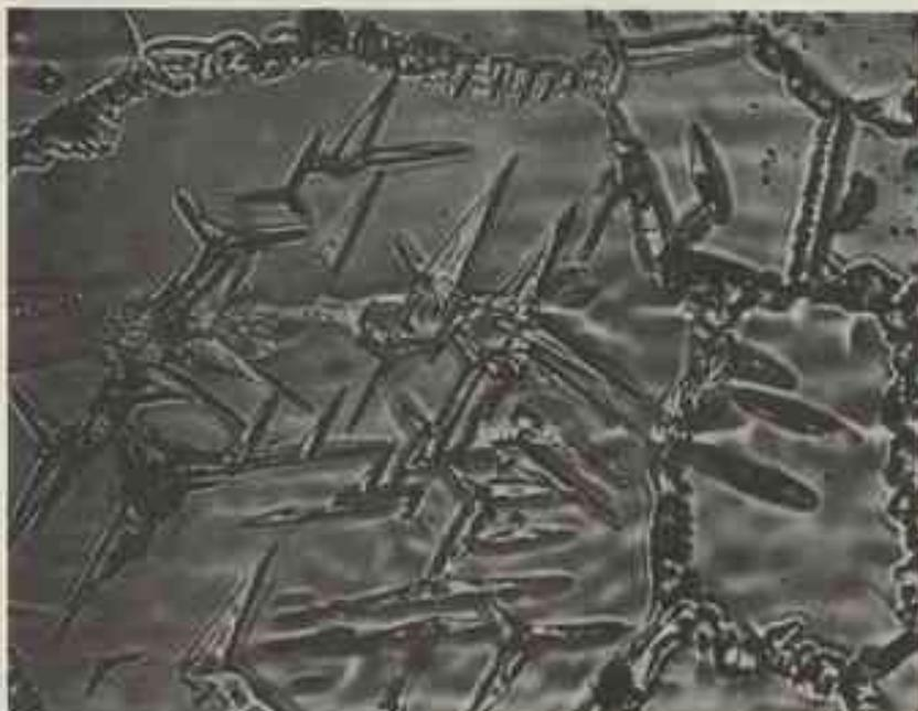
Étude de la germination et de la croissance du carbure TaC à la surface d'un ruban de Ta taillé recrystallisé.
