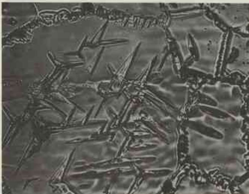
Etude de la germination et de la croissance du carbure TaC à la surface d'un ruban de Tantale recristallisé.
