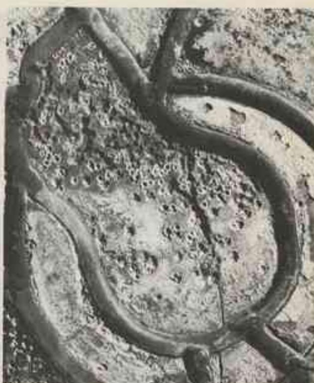
Fig. 2 - Altération uniforme, produit de corrosion composée de gypse et de syngénite. Vitrail XIII<sup>e</sup> siècle, St-Germain (Isle-Cette).
