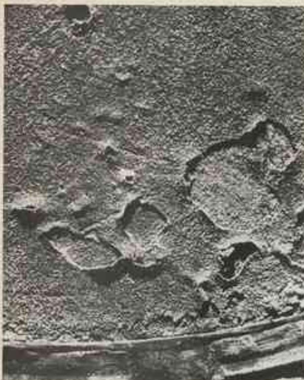
Fig. 1 - Altération du verre par oxydation. Vitrail du XIII<sup>e</sup> siècle, Rouen.
