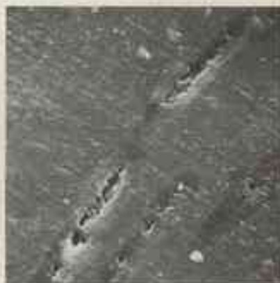
Fig. 6 - Formation de piqures sur une rayure provenant d'une précédente restauration. Observation à balayage G = 1000x (laboratoire de physique des matériaux).
