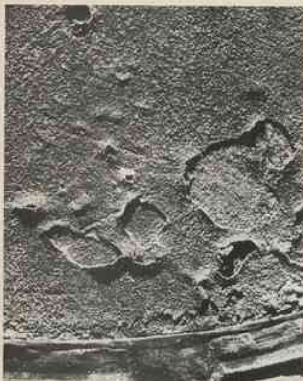
Fig. 1 - Altération du verre par acides. Vitraux du 12 e siècle, Rouges.
