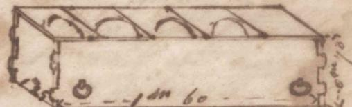
à châssis à quatre traverses cintrées en planche
