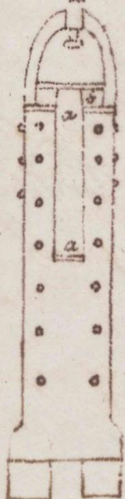
a, a partie de la plaque de côté à enlever du côté opposé à l'attache du câble
